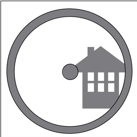
4.2. Wenn Sie durch das Sucherfernrohr schauen (es sollte eingeschaltet sein), sehen Sie das gleiche Gebäude, aber in diesem Fall werden der rote Punkt und der Schornstein nicht zentriert. Stellen Sie das Sucherfernrohr so ein, dass sich der rote Punkt des Sucherfernrohrs leicht bewegt, bis er zum Schornstein ausgerichtet ist. Damit kann die Position der Objekte im Sucherfernrohr korrigiert werden. Um ein zufriedenstellendes Ergebnis zu erzielen, ist ein systematisches Ausprobieren erforderlich.
